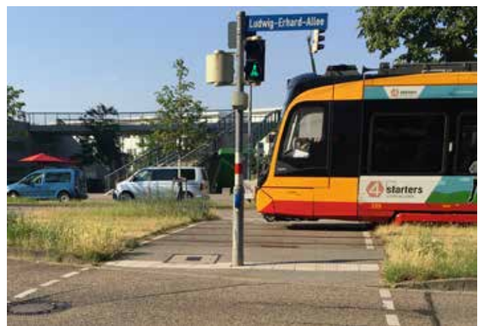
Zum Beispiel Sicherheit: Überweg Ludwig-Ehrhard-Allee – hier fehlt die Synchronisierung der Ampelschaltung und die Wegführung für Fußgänger und Radfahrer ist zu schmal.
